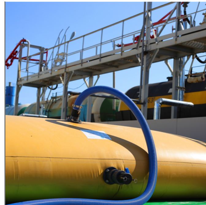
РЕЗЕРВУАР ДЛЯ ХРАНЕНИЯ ЖКУ ОБЪЕМ - 60 м 3
